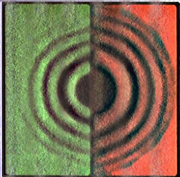
Рис. III. Кольца Ньютона в отраженном свете: 1 — в белом; 2 — в зеленом; 3 — в красном.
